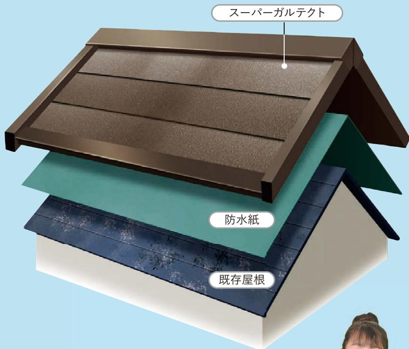
既存屋根の上に防水紙を貼り、その上に新しい屋根材を施工するリフォームを「カバー工法」と言います。既存屋根の撤去・廃棄が不要で工期が短いのが特長です。
